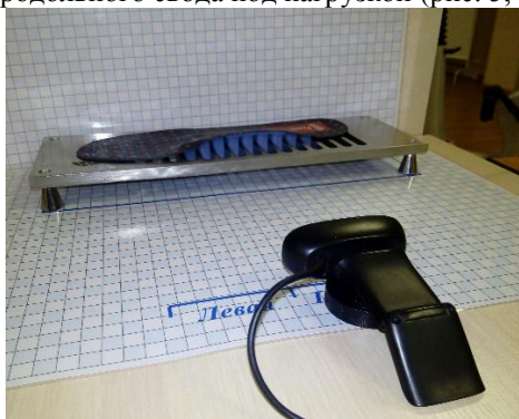
Рис. 5 Расположение корректирующей решетки со стелькой и веб-камеры для фото диагностики высоты продольного свода ( l = 0.15 m, пример для левой ноги)
